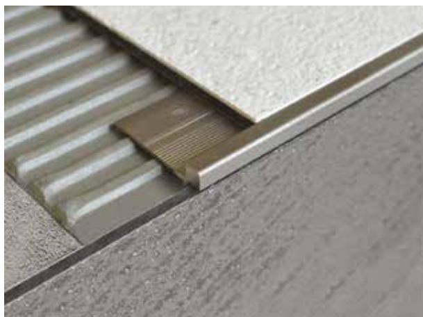
Perfiles técnicos y de diseño para el acabado de peldaños con baldosas "de bajo espesor". Protegen el borde de los peldaños de golpes e impactos mecánicos que podrían comprometer la estanqueidad de los materiales que componen la huella y la elevación del peldaño. El tope FVT está diseñado para ser aplicado antes de la colocación del pavimento, la forma minimalista del borde distingue su forma y lo hace minimalista y moderno.
